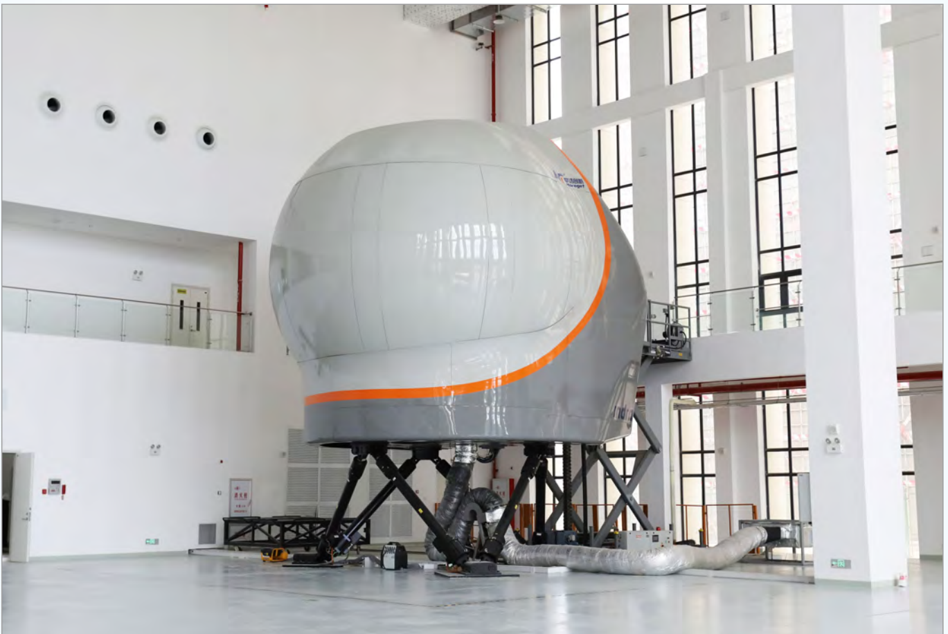
2024年7月20日部署自主研发的AS350直升机D级(最高级)飞行模拟器
